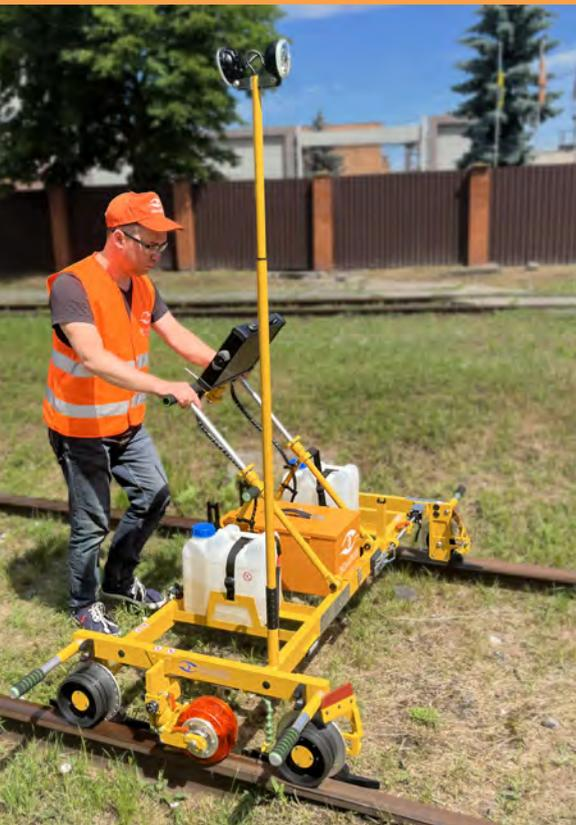
Die Position der elektronischen Steuer- und Visualisierungseinheit ist in drei Achsen verstellbar. Die Elektronikeinheit verfügt über die Schutzart IP65 nach EN60529.
