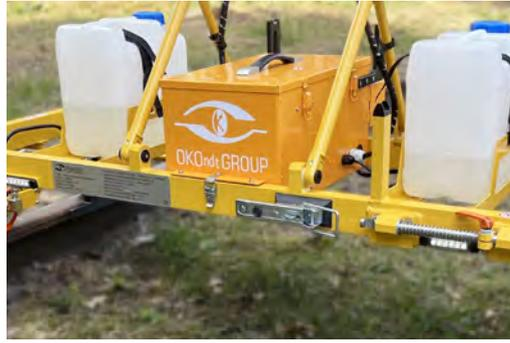
Das Design beinhaltet ein System zur ständigen dynamischen Verfolgung der Spurbreite, dank dem sich das Messrad (RSUI) während des Inspektionsprozesses immer in der optimalen Position zum Schienenkopf befindet.
