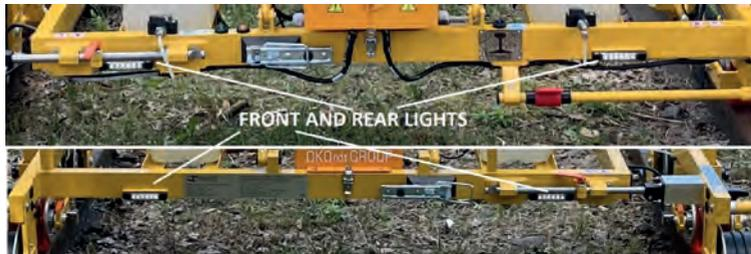
Die Beleuchtung des Scanbereichs vereinfacht den Prozess der Ultraschallprüfung, und die auf der ausziehbaren Strebe angebrachte Hauptrichtungsbeleuchtung erhöht die Sicherheit des Personals bei der Ultraschallprüfung erheblich und sorgt für eine weitreichende Beleuchtung in Bewegungsrichtung.
