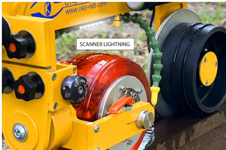
Das Fehlerprüfgerät ist mit speziellen Geräten ausgestattet, die eine sichere Fahrt des Fehlerprüfgerätes über Weichen und Kreuzungen, unabhängig von der Bewegungsrichtung, gewährleisten.
