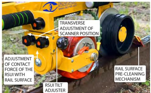
Die Positionierung jedes Radscanners erfolgt über mechanische Justierungen.
