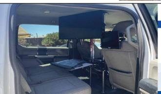
c) der Bedienerarbeitsplatz mit Kontrollmonitoren befindet sich auf dem Rücksitz in der Fahrzeugkabine.
